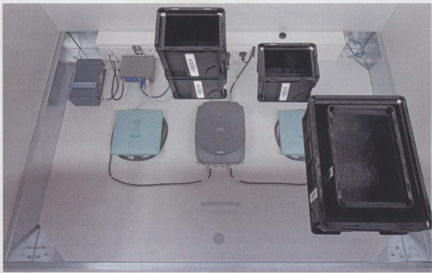
图 3 RFID 读写器上连接有两根可拆卸下来的 Simatic RF640A 型 UHF 天线，托盘标签箱里的标签数据由客户将其传递给 Würth 工业服务公司物流中心
