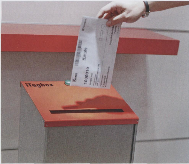
图 2 I-Tagbox 是为供应笨重部件的托盘 Kanban 系统而设计的，可通过一个“智能信箱”进行校对分析，货物需要通过向“智能信箱”里投入有 RFID 标签的 Kanban 卡发出信号。I-Tagbox 的天线直接与托盘标签箱的 RFID 读写器相连接
