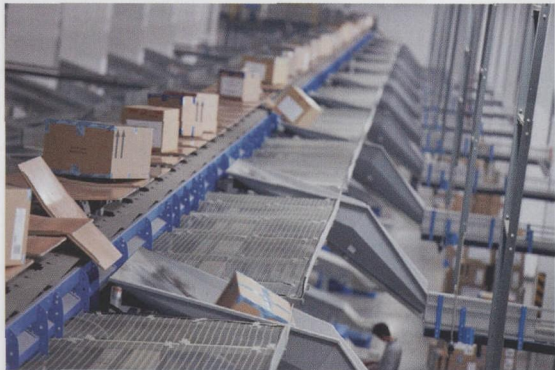
图 3 Beumer 公司的货物分拣系统在世界范围内运用于邮电和物流配送中心
