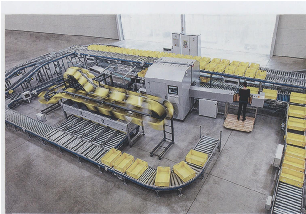
图 5 SSI Schäfer 公司的批量拣选扫描货物分拣系统将货物处理和扫描程序按照客户合同委托进行分拣组合
