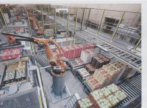
图 1 新抓取系统码垛机器人集合了 15 个工作站，实现全自动托盘拣选、包装和码垛作业
