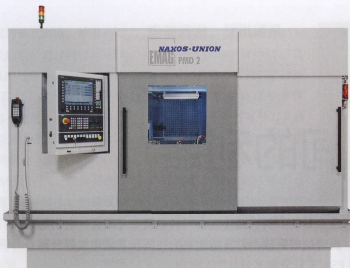
图2 曲轴磨床造型紧凑。例如在机罩上设有开关柜和能源集装箱
