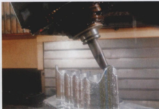
图 2 旨在打造汽车发动机缸体周围冷却回路，这种“栅格结构”模芯受益于 DMG MORI 中心的 hyperMILL 编程
