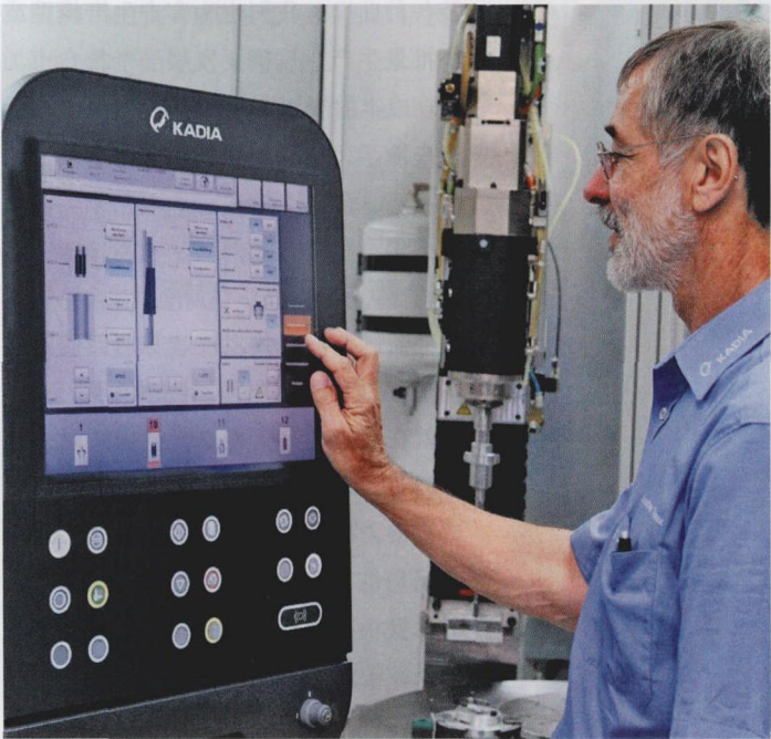
图 2 HMC100 控制面板，KADIA HMC100 控制系统的面板为整个珩磨和测量程序提供了杰出的操控性
