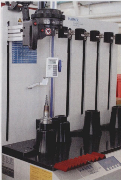
图 4 更高端的解决方案用于专业的加热和冷却需求：Haimer 的超级型热缩机提供了更宽敞的工作台面，操作简单，导轨式的冷却套并带有温度监控
