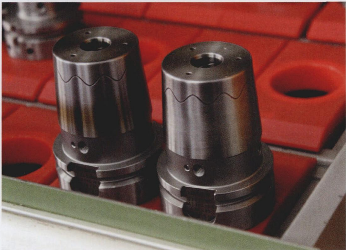
图 2 因为加强了夹持壁以及其他的结构特点，Haimer 的重型热缩刀柄拥有强大的夹持力能够适用于大尺寸刀具的粗加工
