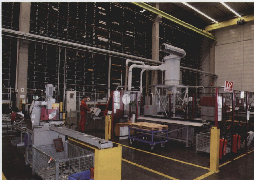
图 1 欧洲直升机公司（Eurocopter）车间一隅。其购置的贝灵格锯切设备可很好地满足高架存储系统中多种原料的锯切
