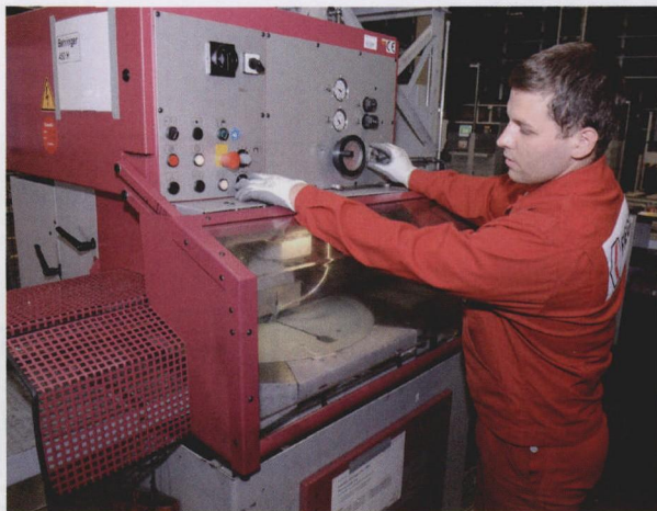
图 2 Fiege 公司员工正在操作贝灵格·埃赛乐 PSU450A 圆盘锯床
