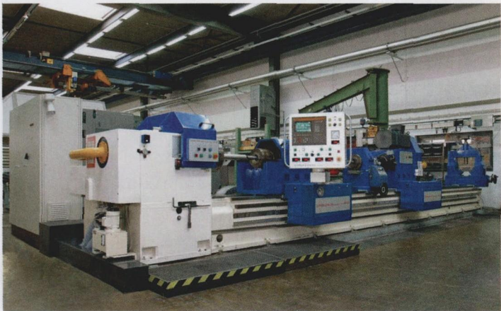
图 2 在进行强化工艺试验时，研发人员使用的设备是 Giana GGB 560 型深孔钻削设备
