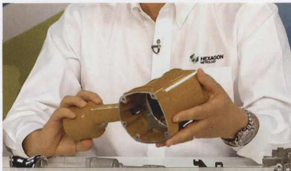
图2 这个接受了激光扫描检查的铝压铸外壳有可能存在一些要求采用指针式探查或模拟式扫描的表面形状
