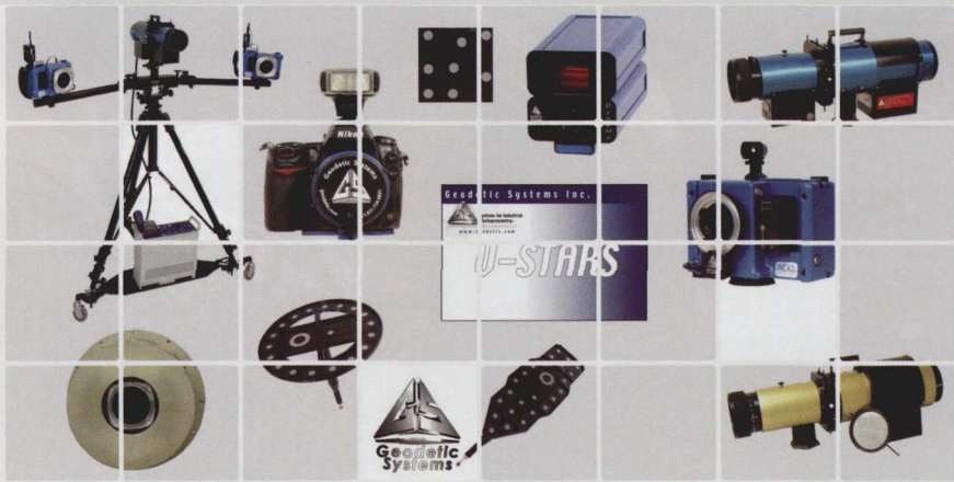
图 3 V-STARs M 摄影测量系统组成
