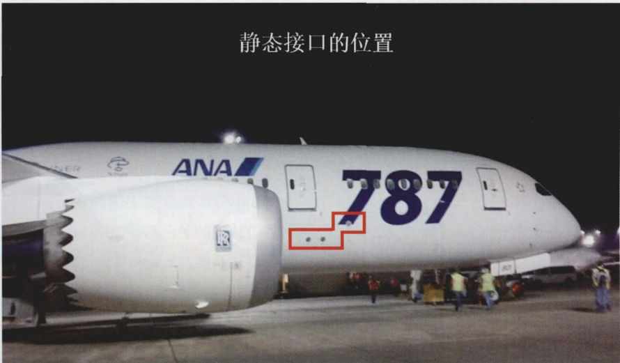
图 1 空气动力团队要求使用飞机的静态接口测量的数据用于评估 RVSM 数据
