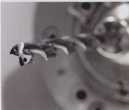
图 3 内冷却方式对刀具的使用寿命、切屑排放和表面质量均产生积极的影响
