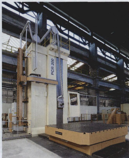
图2 旋转台最大可以承接 75 t 重的工件
