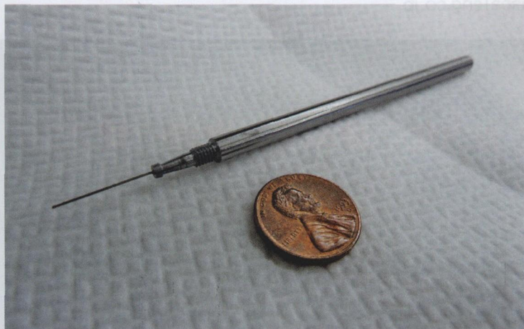
图2 在压缩冠紧固后，打孔范围变成 0.0135~0.0280 in，将钻孔固定在接长钻中
