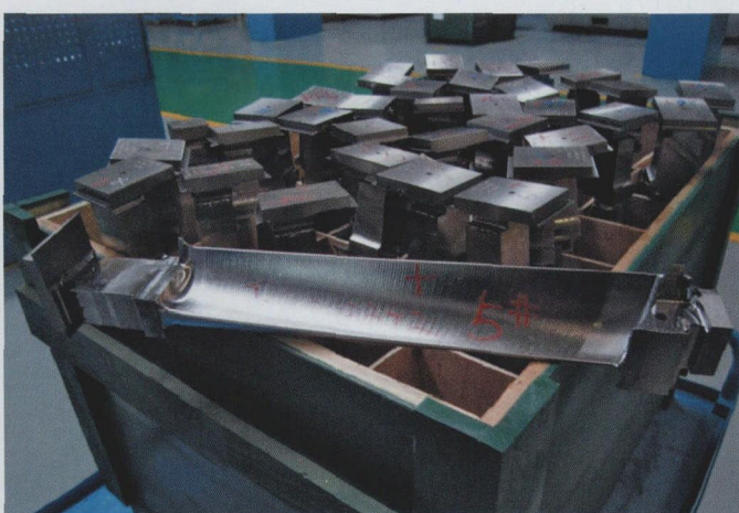
图 1 叶片的结构复杂，多为扭转自由曲面
