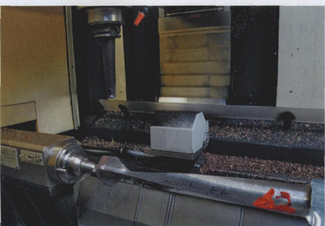
图 2 叶片的加工工作量很大，几乎占到了汽轮机总加工量的 1/3
