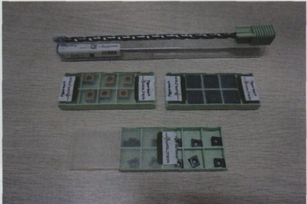
图 2 在江淮铸造分别使用了瓦尔特刀具最具代表性的三个产品系列：瓦尔特·蒂泰克斯 (Walter Titex) XD 深孔钻，Walter BLAXX™ (黑锋侠) 和 Tiger·tec® 老虎刀片
