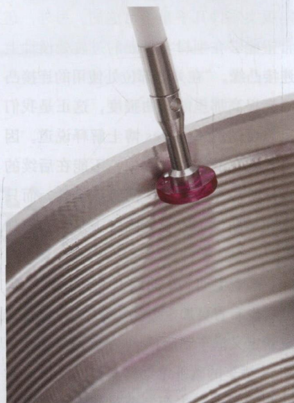
图 2 盘式探针可以很理想地应用于探查底切口和凹槽。简单的盘式探针只能探查 X 轴和 Y 轴方向, 但添加一个径端辊就可以探查 Z 轴, 而前提是这个辊子的中心点应当伸出至探棒直径以外
