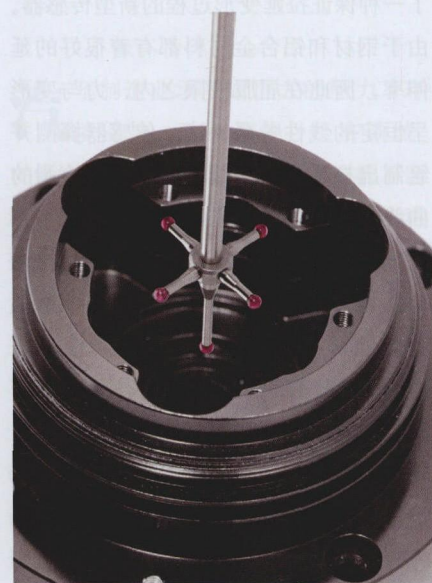
图 1 这个星形探针方便以最少探头移动实现对内部形状极点的检查工作
