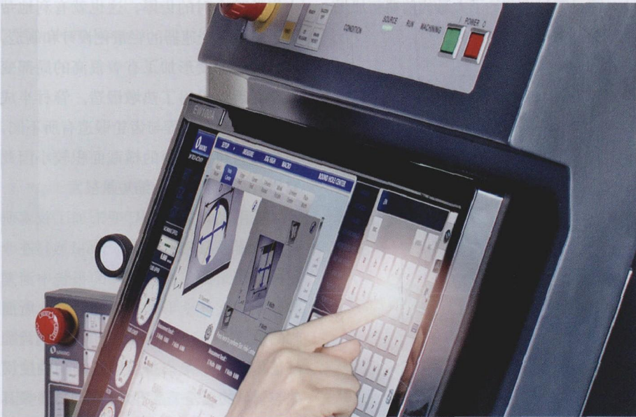
Hyper i 控制装置基于的理念是线切割加工的操作人员界面应具备直观性、智能化以及交互性，采用的触屏导航功能借鉴于智能手机与平板电脑技术
