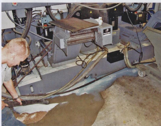
图1 冷却液传输系统产生的泡沫非常严重, 以至于 LB Pipe&Coupling 不得不在现场准备液体吸收剂来收取飞溅到地上的泡沫, 因为泡沫会导致高压泵关闭
