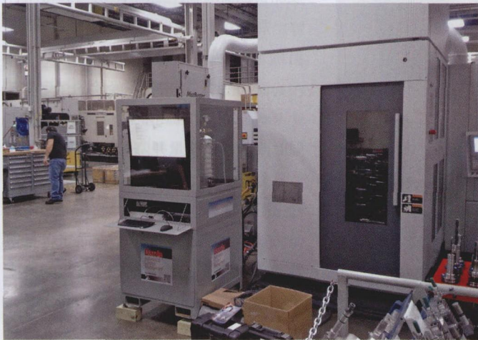
图 1 Dazzle Island 版是一个能保持机器冷却液浓度的专业装置
