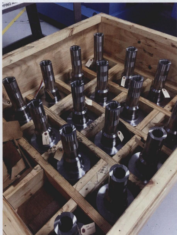
图 4 这些行星齿轮正在等候机加工车间进行深度磨齿，该工序将带来更严紧的公差和优异的表面粗糙度
