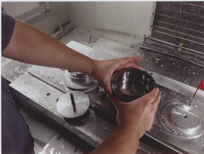
图2 装载到 Haas VF-2SSYT 立式加工中心上的齿轮为的是执行其他机加工作业
