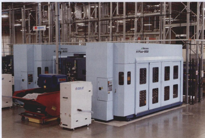
图2 这套托盘系统为两台 Matsuura H Plus-500 卧式加工中心服务。这两台 4 轴、50 锥度机床配有 320 位刀库、高压冷却系统和将切屑排至大型切屑箱的大容量切屑输送机
