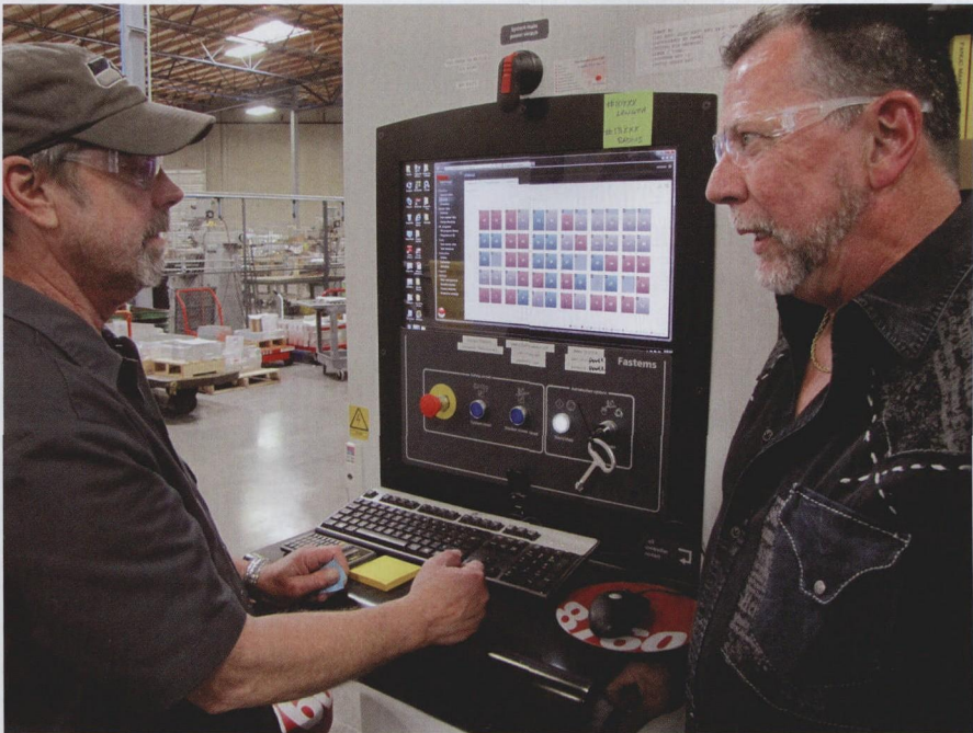
图 4 加工单元团队领导者 Rick Nelson（左）正在与 Paul Hogoboom（右）回顾加工单元的运行情况。在加工单元主指令站，Fastems MMS5 控制系统提供了用于与加工单元团队互动的软件工具和显示屏幕。这个屏幕以色彩编码格式指示了全部 60 个托盘的状态
