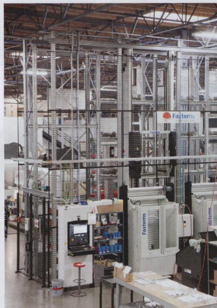
图3 这张托盘系统照片揭示了托盘货架具有异乎寻常的高度。这个加工单元是美国第一套在 20 ft 高货架内设置了 5 个贮存层的 Fastems 系统
