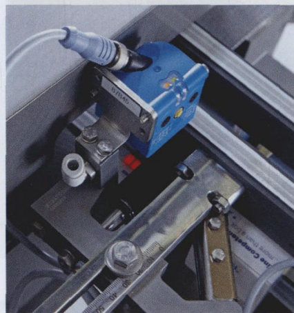
图2 GLARE 光泽传感器开发始终是达到 prEN 16679 标准的目标“包药品包装防伪检测标识”
