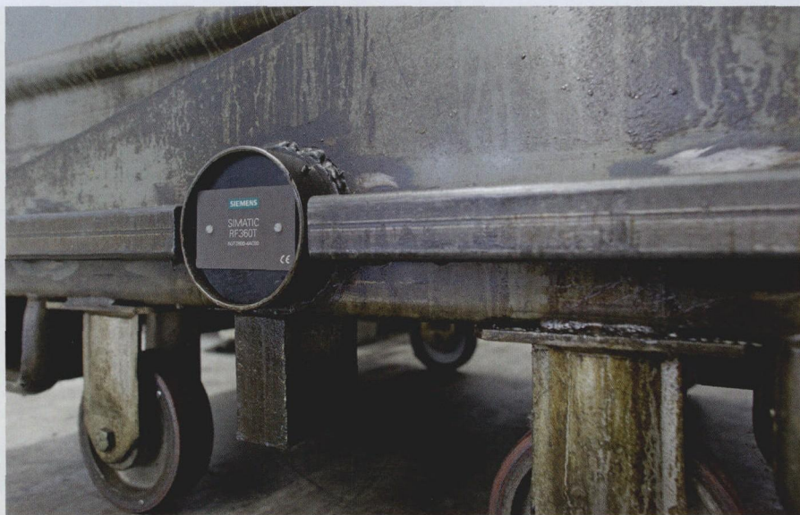
图3 全部 23 个底部开门自动运输设备装有可准确检测和分配废弃材料重量的 Simatic RF360T 型 RFID 转发器
