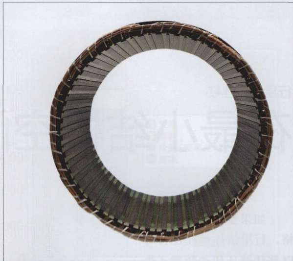
图3 在占地相同的情况下，采用铜线圈的力矩电动机具有更高的效率
