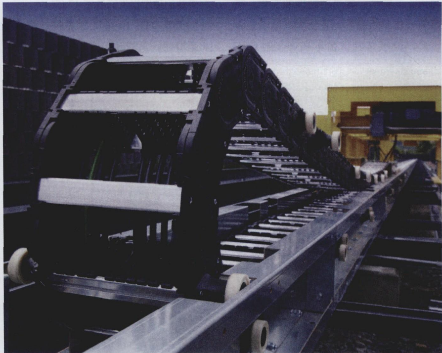
RSC 是应对额外负载高以及行程长的理想解决方案，尤其适合 200 m 以上的行程范围
