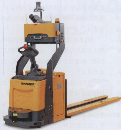
图 1 Jungheinrich 的 225 a 型全自动托盘搬运车, 新 APM 车型将随之而来
