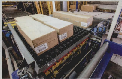
“Casewheeler”系统在 MVN 为 Migros 公司销售点供货的全自动低温深冷配送中经受了考验
