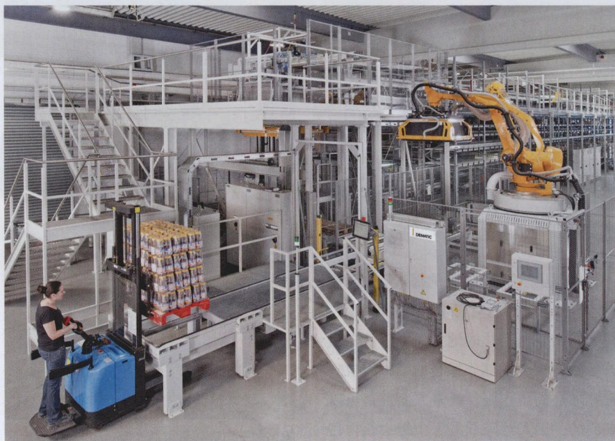
图 1 自动高效托盘系统 Amcap 占地仅约 50% 的空间，在深冷区节省能耗达 50%
