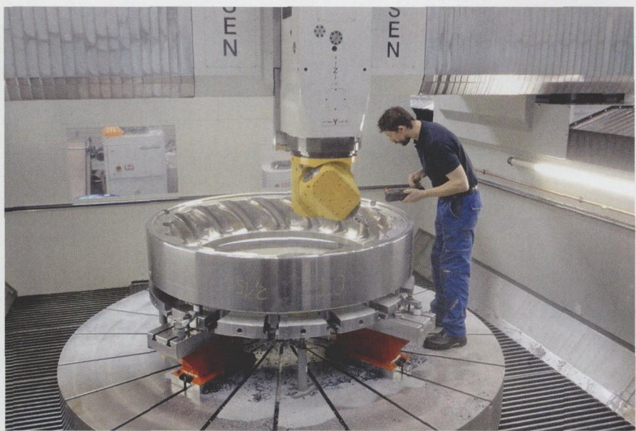
图 1 带有圆形工作台的龙门铣床；趋势是对精度要求越来越高
