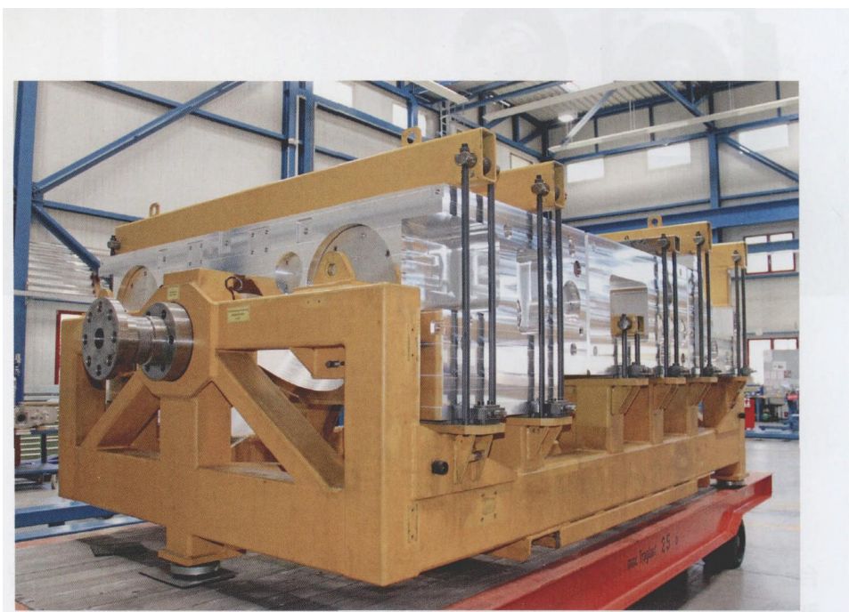
图 1 从 16 t 铝材中生成 4.5 t 重、4.5 m 大小的机身。机身由四个单独部件构成,四个单件在焊接装置上被加工成一个整体部件
