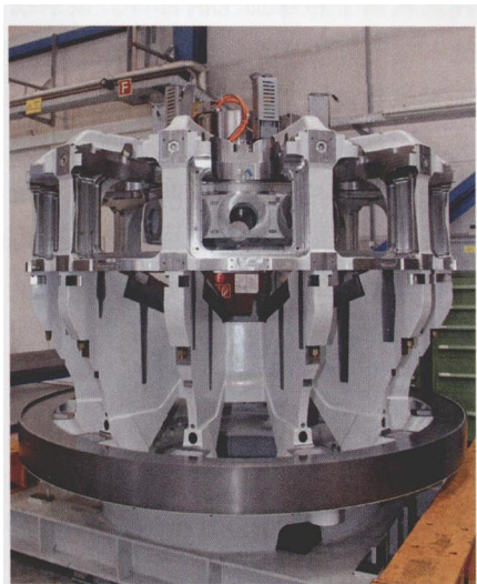
图 4 这种全自动圆转台装置不久将发往瑞士的 Mikron 公司。它适用于一种带有 12 个工作站的机床，而每个工作站都可以采用小型的五轴加工中心
