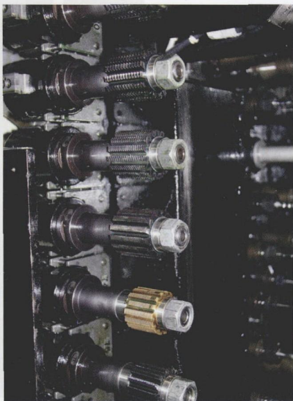
图3 多轴加工使公司能够将工艺标准化，减少其螺旋和正齿轮的制造设置
