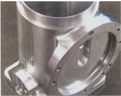
图 3 KPI 制造优质 CNC 加工零部件，着重强调低数量和快速周转。这是其生产的一小部分零件的实例
