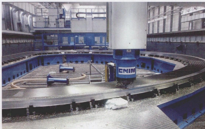
图2 辐板是放置并支撑反应堆芯即聚变室的重要组件
