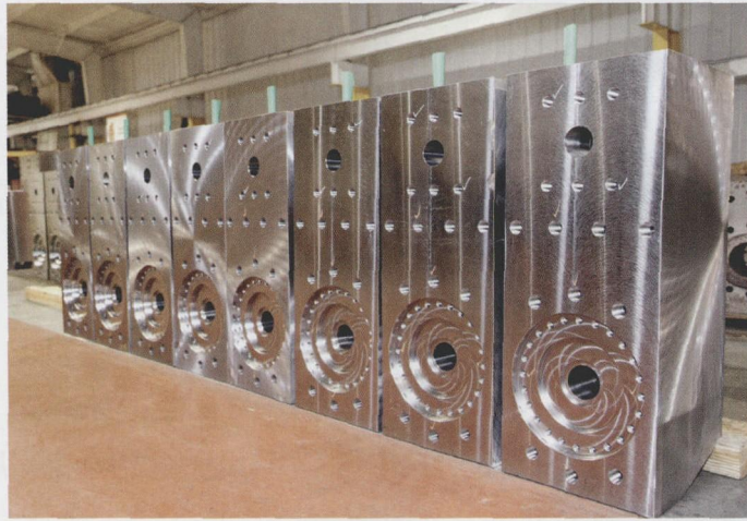
图4 阀箱模块孔非常密集。因此，流水化刀具更换和刀具管理对整个工艺的流水化有显著的贡献
