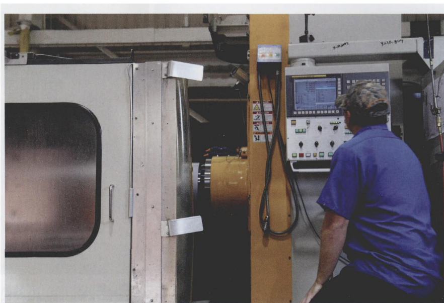
图 1 安装能够进行粗加工和细加工的卧式加工中心是 Southwest Oilfield 提高生产 L 型阀箱能力的关键
