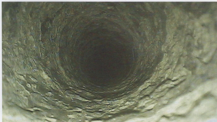
图1 “它看上去就像我吃了甜甜圈后的动脉。”电厂的一位工程师在看到这张照片时开玩笑地说。不幸的是，为了这张照片，发电厂每年在增加的燃料消耗方面耗费了 115 Btu/kWh 的效率和 74.5 万美元的成本
