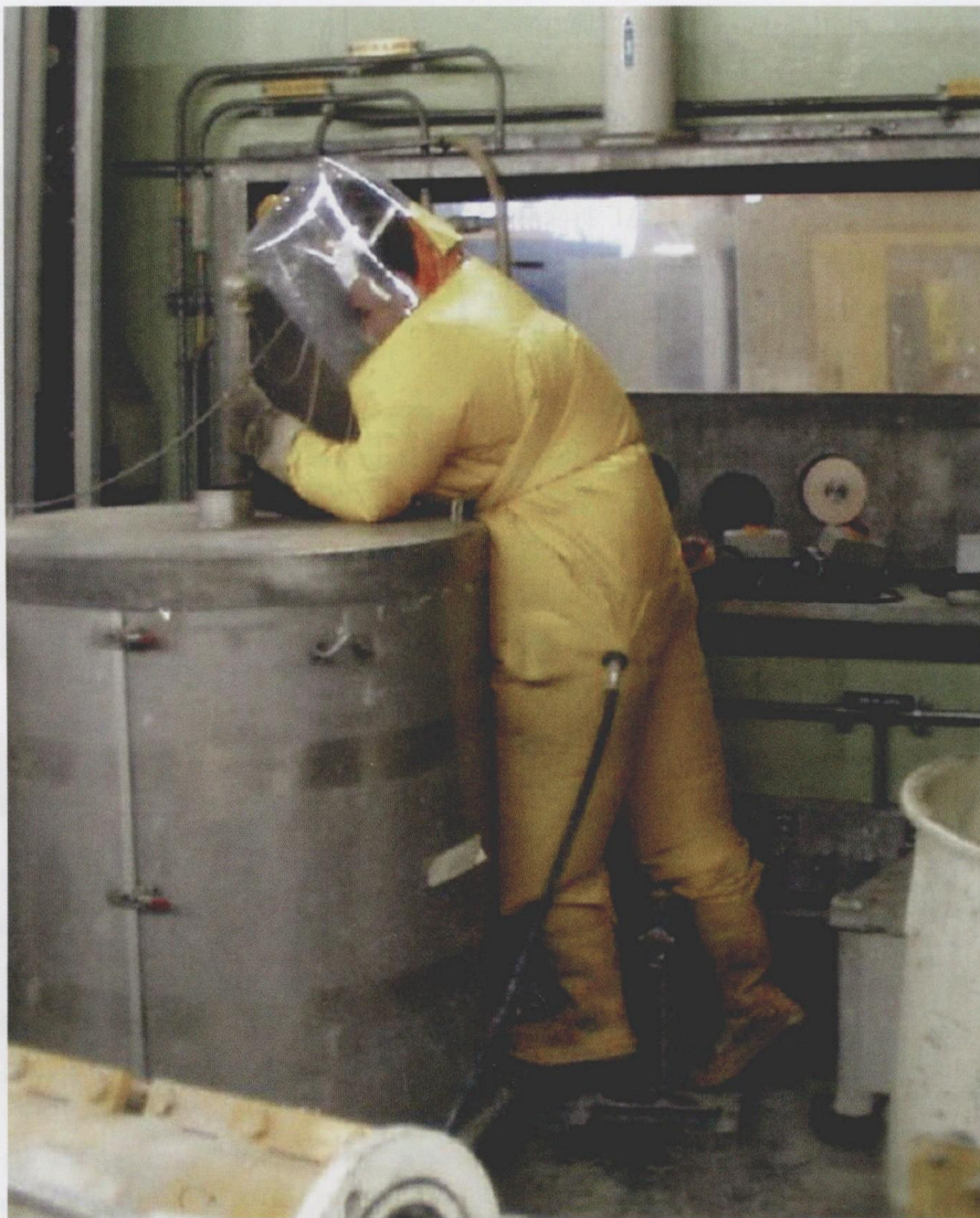
图1 拆卸受核辐射污染的零部件时，劳动保护是第一位的，拆卸工人要穿戴好外部供氧的防护服和配戴无线通信设备
