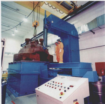
图 3 利用专用的带锯即可在大气环境中在水中将大型零部分隔成小块
