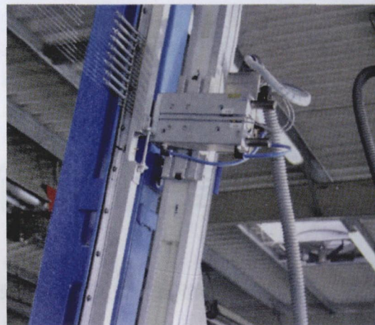
图 3 夹持器的安装细节在线性模块和导轨上进行，然后按所有新的电热丝数量再调整。
