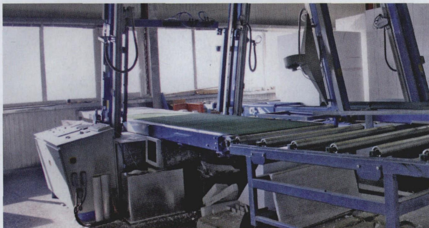
图 2 在这个总成设备中 EPS 块件按维度为 3000mm*1200mm*1200mm 进行切割。
