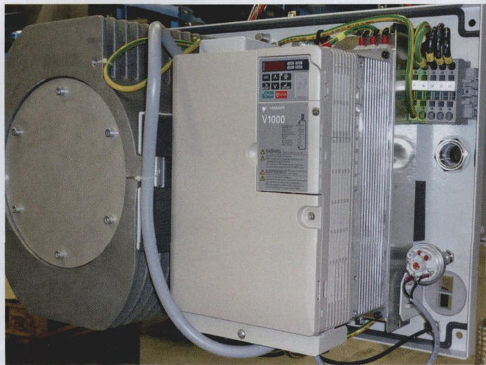
图 3 配有变频器的泵和空压机可以按需求随时调节所需工作
