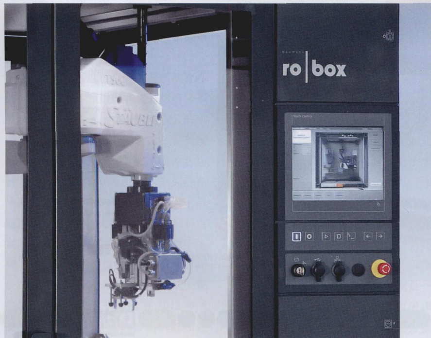
设计重心是人与机器的交集点，符合人体工程学设计的多功能触摸操作屏有很强的实用性，两面都可以集成，这样机器人单元操作更加灵活
