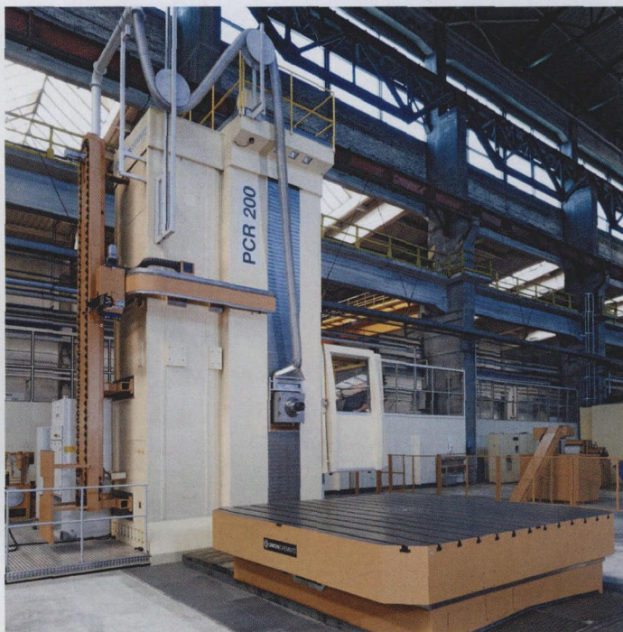
图 2 高精度的静压导轨滑枕
