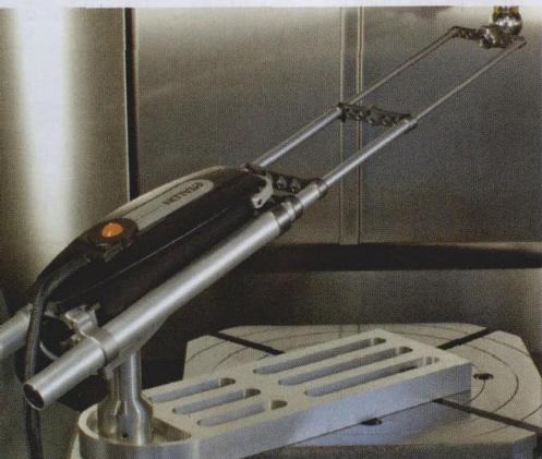
图 1 MT 型激光校正器特别适合于在机床狭窄的工作腔里进行测量
