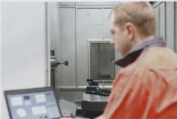
图 2 该测量装置与一个软件相组合能够测量分析机床的整个工作腔
