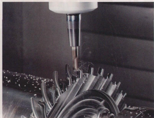
图2 锥颈球头变形金刚立铣刀 (MULTI-MASTER) 刀头的采用提供了可接受的, 更经济的方案
