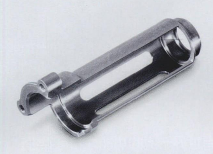
图 3 DECKEL MAHO 斯巴赫“保时捷赛车数控技术中心”生产的零部件举例电机壳。DMU 60 eVo linear 铣削。材质：铝。加工时间：105 min
