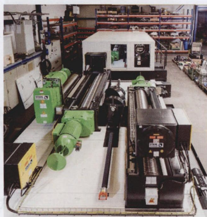
图 2 副钩（SH 钢丝绳葫芦，左），主钩（AS 7 钢丝绳双葫芦，中右），控制和加热系统在其中一台双梁小车上
