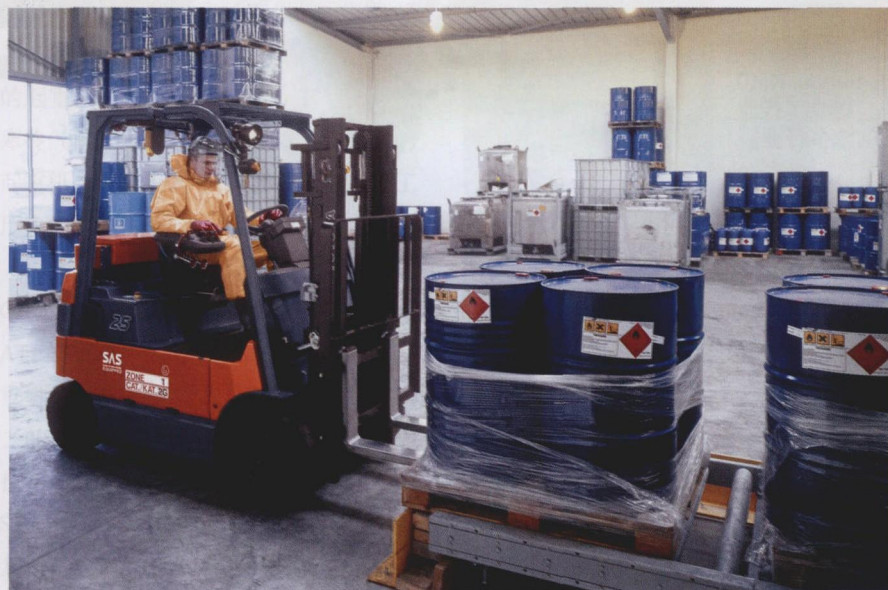
用于有爆炸危险区域的电动叉车 7FBMF，电池电压 80 V，涵盖 1.6 ~ 5 t 的承载等级
