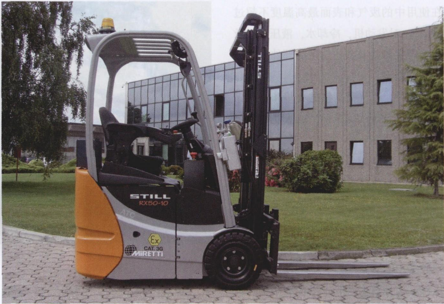
图 3 Still 公司整个产品目录中的绝大部分都可以提供防爆型叉车
