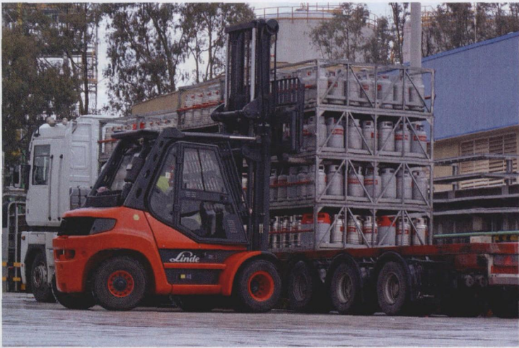
图 1 对于在防爆区域的使用，Linde 公司可提供两种新型柴油叉车 H50 EX 型和 H60 EX 型
