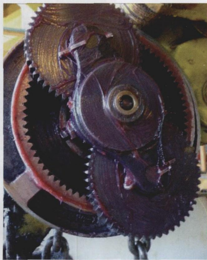
“油脂润滑系统”有效的防止润滑油滴落至海洋
