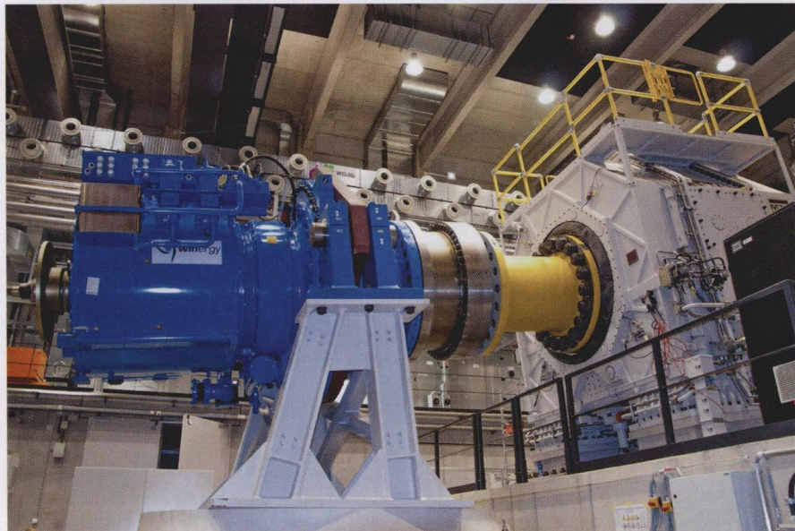
图2 现在，RWTH 高等技术学院的风力发电设备测试中心可以对重量高达 100 t 的风机舱进行测试
