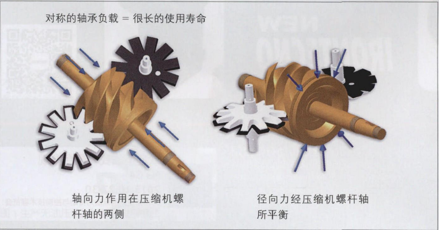
图 3 较低的转速和较低的对称受力保证了很长的使用寿命
