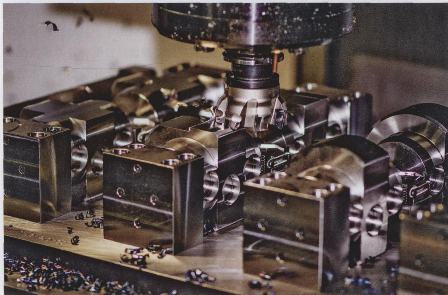
图 2 高密度加工也在直立机器上进行,这样减少了必要工具更换次数,增加加工效率
