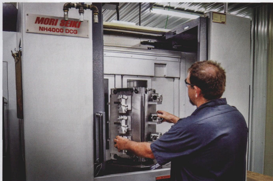
图 1 作为高密度加工中使用的一个零件，J&R Machine 开发出一些允许在同一设置下加工各种零件的夹具
