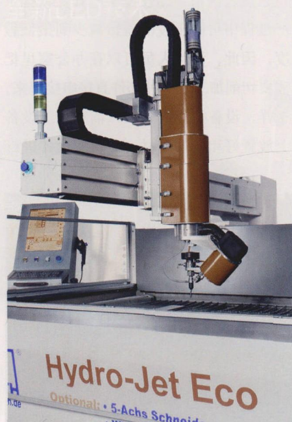
图 2 Knuth 公司的 Hydro-Jet 型切割设备，配有一个可在五轴上移动的 3D 切割头，并可绕着垂直方向作任意旋转
